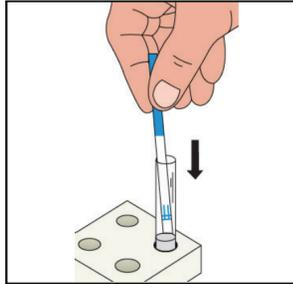
Den Aluminiumschutzbeutel öffnen, den Teststreifen am blauen Ende festhalten und in das Röhrchen mit den Extrakten geben. Mindestens 5 Minuten und höchstens 10 Minuten im Röhrchen lassen, damit die Reaktion stattfinden kann.
