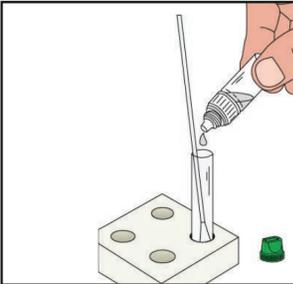
Anschließend die Tropfflasche mit **grüner** Kappe öffnen (nur die grüne Kappe abschrauben, die weiße Kappe fest verschlossen lassen), die die Extraktionslösung 2 enthält, geöffnet, 6 Tropfen in das Röhrchen geben und die Flasche wieder verschließen.
